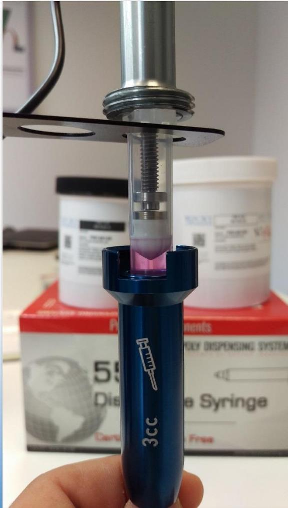
Die Pistole von oben auf die Kartusche aufsetzen und den Gewindekolben bis kurz vor Anschlag an den Stopfen herantreiben.
