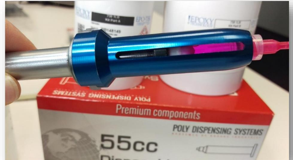
Wenn sich Klebstoff im Bereich des Gewindekolbens befindet, den Dosierprozess abbrechen, das Cover abschrauben, die Kartusche entnehmen sowie die nachfolgenden Schritte durchführen.
